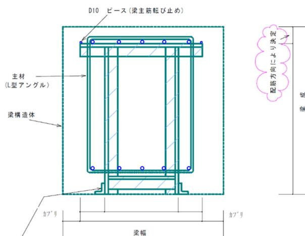
・梁架台が安定するように、足元にアングルを取付ける。
